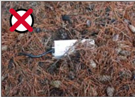
Netzteil vergraben Power supply buried Enterrer la source d'alimentation
